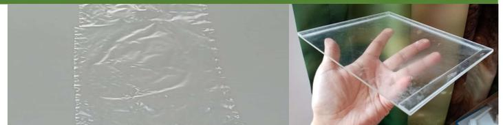
Figura 2. Película de almidón termoplástico (TPS) y molde de acrílico usado.
