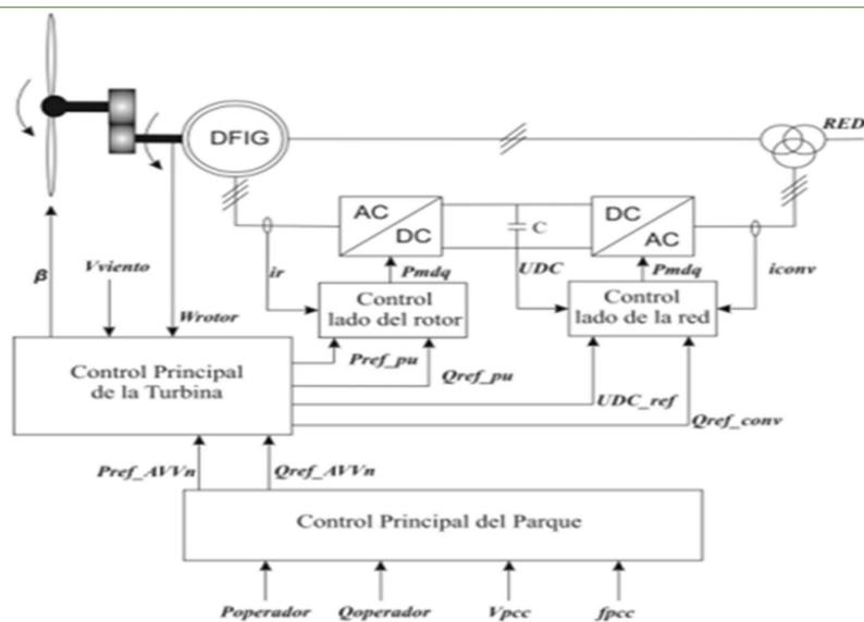
Fig.1 Diagrama esquemático DFIG ( TOLEDO, et al 2014)
